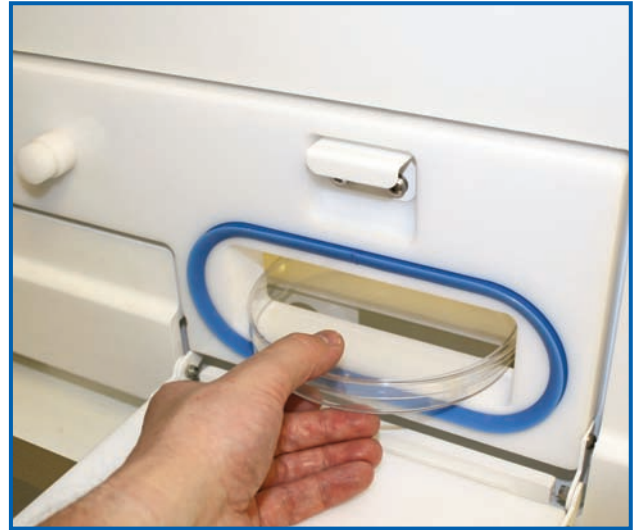
Optionaler 15cm Einplatteneinschub – für das schnelle Einbringen von einzelnen Proben
