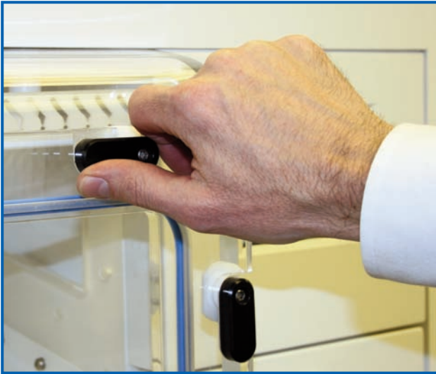
Optional erhalten Sie eine abnehmbare Frontscheibe, durch die große Proben und größere Behälter in die Bank eingebracht werden können – auch die Reinigung fällt leichter
