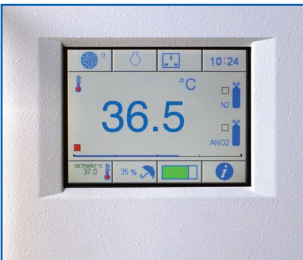
Bedienung mittels intuitiver Software via farbigen Touchscreen
